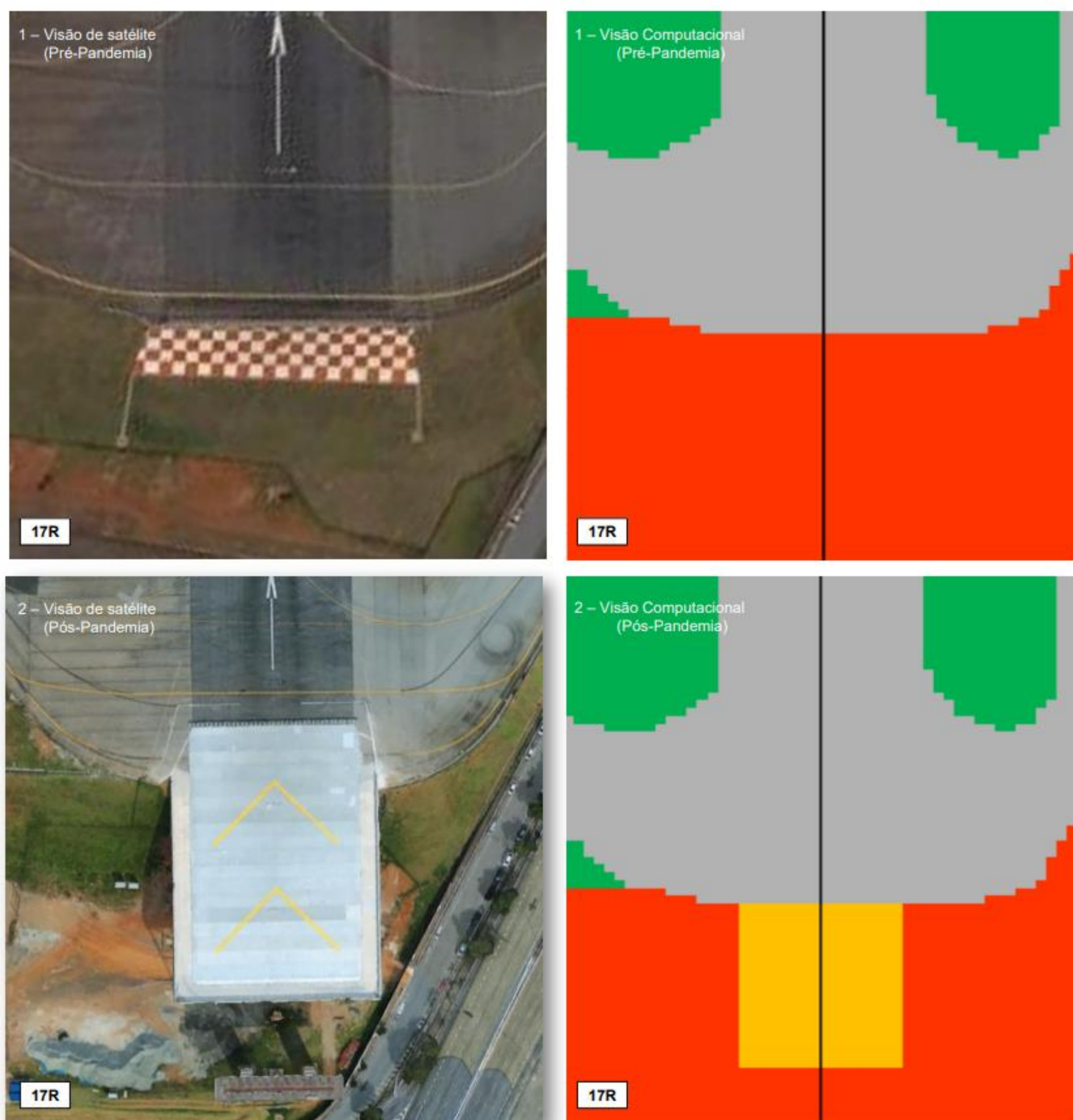
Figura 6: RESA sem EMAS (1) e RESA com EMAS (2)
